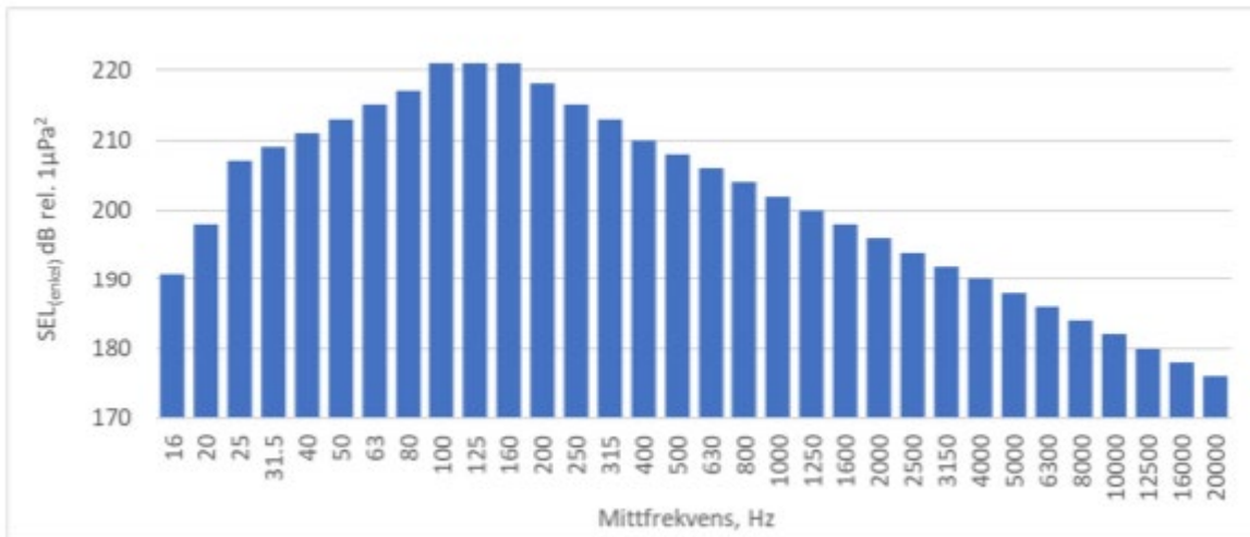
Figur 49. Tersbandsnivåer för undervattensbuller vid pålning. Nivåerna har anpassats till källstyrkan SEL_{(enkel)} 228 dB. Tersbanden bygger på medelvärdet av de i Bellman et al. 2020 redovisade nivåerna.
